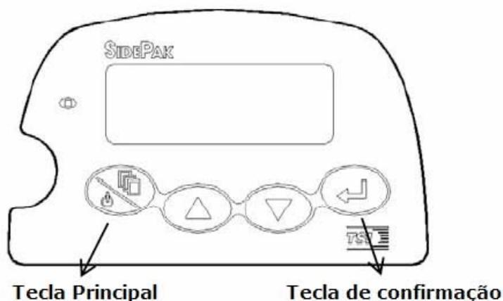
**Figura 2: Painel frontal do SidePak, com indicação das teclas principais**
